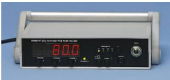
Измеритель параметров реле ЧИ 2400 предназначен для измерения временных параметров переключения контактов реле. Может использоваться в качестве миллисекундомера.
