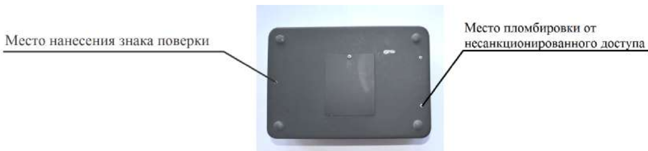
Рисунок 2 - Схема пломбирования приборов
