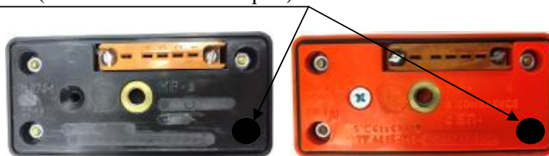
а) б) а) – Метанометры МГМ-1М б) – Метанометры МГМ-1.1М Рисунок 2 – Схема пломбировки от несанкционированного доступа, обозначение мест нанесения знака поверки
